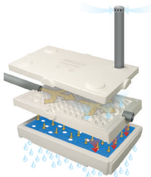
Suodatuskasetin rakenne
